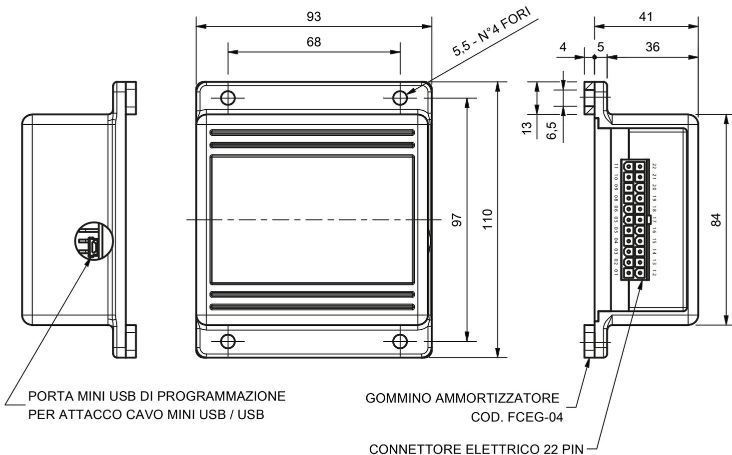
CENTRALINA ELETTRONICA PROGRAMMABILE TRAMITE INTERFACCIA SOFTWARE PER LA GESTIONE DEI PISTONI ELETTRICI TIPO PE40GP. IN FASE DI PROGRAMMAZIONE SEGUIRE L'APPOSITO MANUALE DI ISTRUZIONE FORNITO INSIEME A PISTONE E CENTRALINA
